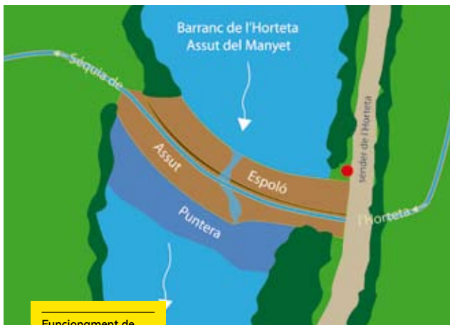
Funcionament de l'assut de Manyet
