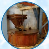
**9. Molino de la Noguera:** Molino hidráulico impulsado por agua, eran las máquinas empleadas para triturar cereales hasta mediados el S. XX. Este es el único molino de este tipo que se conserva en perfecto estado en la comarca, ya que, en los años posteriores a la aparición del molino eléctrico, los antiguos hidráulicos fueron desmantelados.
